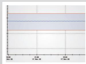
**Hohe Temperaturgenauigkeit** auch im eingebauten Zustand durch Umluftkühlung und leistungsstarke, belüftete Kältemaschine.
