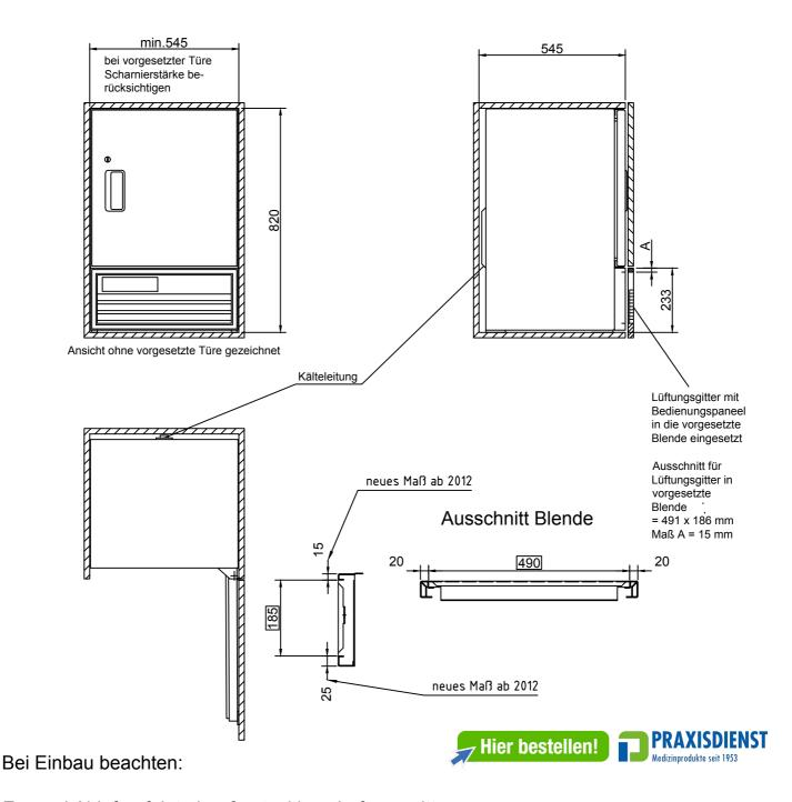
Zu- und Abluft erfolgt über frontseitiges Lüftungsgitter , daher dieses nicht durch Gegenstände zustellen oder Verblenden , damit die Belüftung der Kältemaschine gewährleistet ist.
